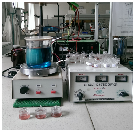
Рисунок 6 – Установка для выполнения исследований по получению медного порошка методом электролиза
